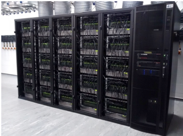
Abbildung 5: Zwei Groß-Systeme zur Nachbildung neuronaler Schaltkreise (links). SpiNNaker-System der Universität Manchester (rechts).
