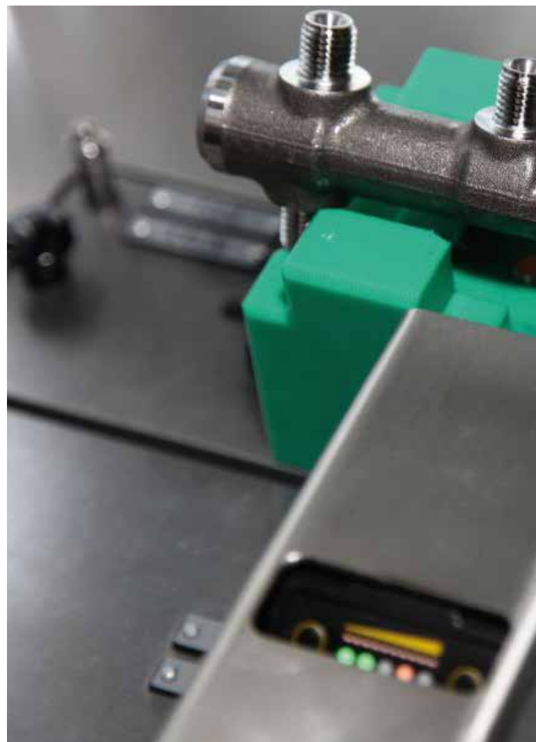
Jedes Bauteil wird mit einem DataMatrix-Code ausgestattet, der Information zentral verarbeitet. (Quelle: Felss Holding GmbH)
