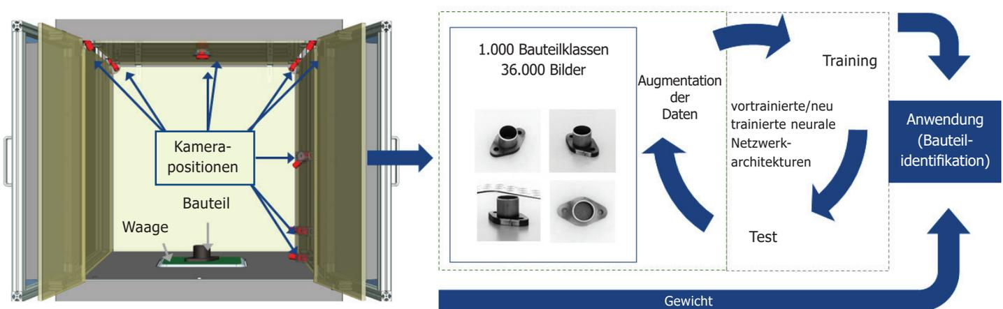
Abbildung 9: Kameragestütztes Assistenzsystem zur Identifikation von Bauteilen in der Ersatzteillogistik
